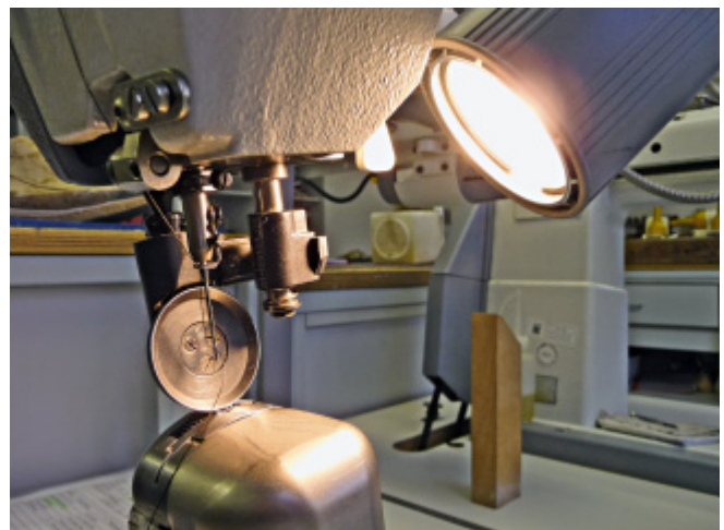
An den Wirkbereich angepasste Beleuchtung
