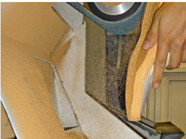
Die Absaugwirkung wird erhöht, wenn die Staubklappen an nicht benutzten Absaugungen geschlossen werden.
