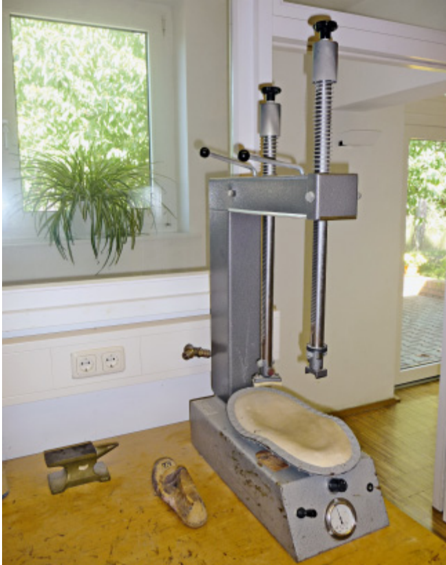
Die Stangen dieser Orthopädiepresse sind gut zu arretieren
