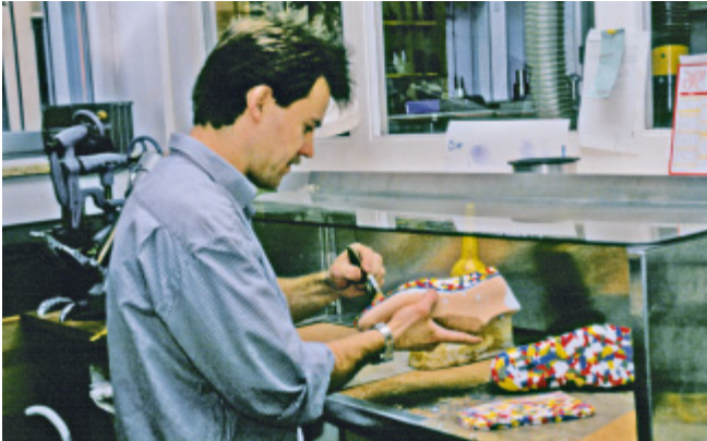
Klebstoffarbeitsplatz mit optimaler Luftführung durch Einhausung
