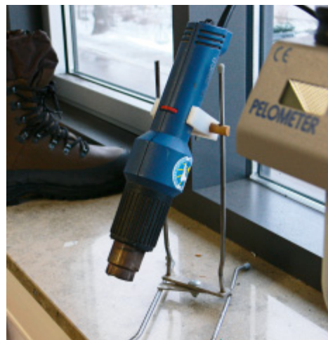
Heißluftfön sicher abgestellt
